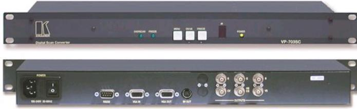
El VP-703SC es un convertidor de exploración para señales gráficas de video por ordenador. Convierte señales gráficas de video por ordenador hasta SXGA (1280 x 1024) a señales de video compuesto, s-Video (Y/C) y RGB (RGSB o RGBHV) simultáneamente en ambos formatos PAL o NTSC.
