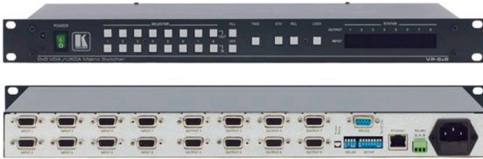
El VP-8x8 es una matriz de conmutación de altas prestaciones para señales gráficas de video por ordenador, con un rango de resoluciones desde VGA hasta UXGA y superiores con conectores HD-15. Puede conmutar cualquiera o todas las señales de entrada a cualquiera o a todas las salidas simultáneamente.
