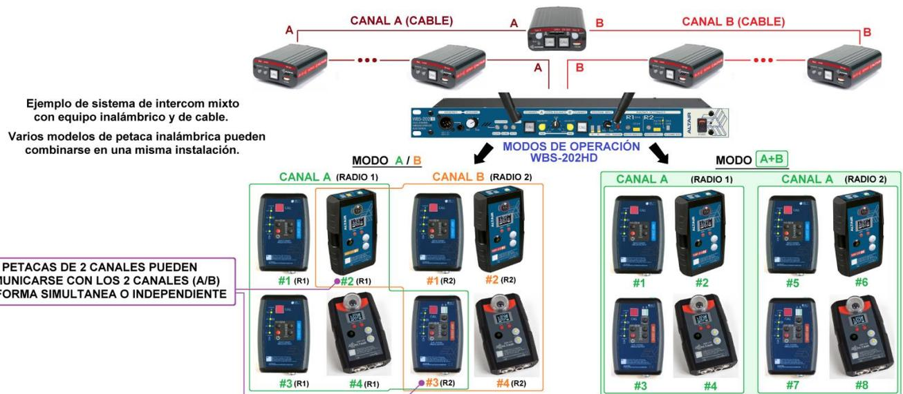
Ejemplo de sistema de intercom mixto con equipo inalámbrico y de cable.
